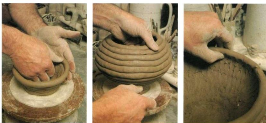
Figura 2 Modelado a rollo. Retomado de libro Guía completa del ceramista.
