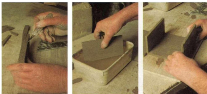
Figura 3 Modelado a plancha o lasca. Retomado de libro Guía completa del ceramista.
