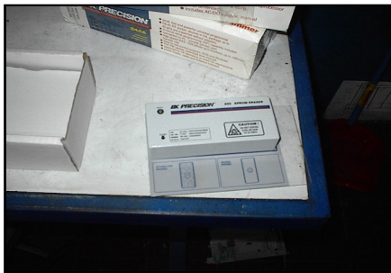
Foto 5.5 Borrador Ultravioleta para memoria ROM.
