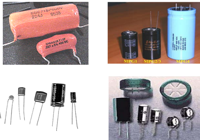
Figura. 2 Diferentes tipos de capacitores.
