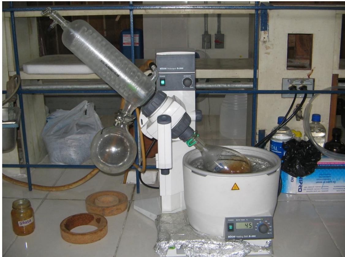
Fig N° 31: Equipo de destilación al vacío, BÜCHI Rotavapor modelo R – 200, para la determinación del grado alcohólico por medio del método oficial de la AOAC.
