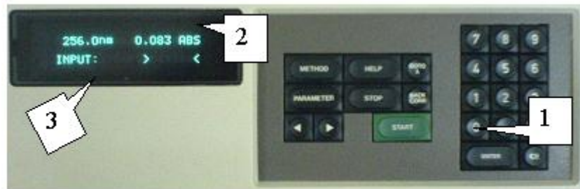
Fig N° 27: Pantalla y tablero espectrofotómetro Perkin Elmer Lambda 12.
