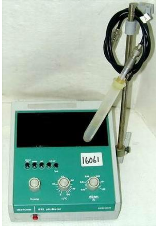
Fig N° 28: pH – metro Metrohm 632 y electrodo de calomel.
