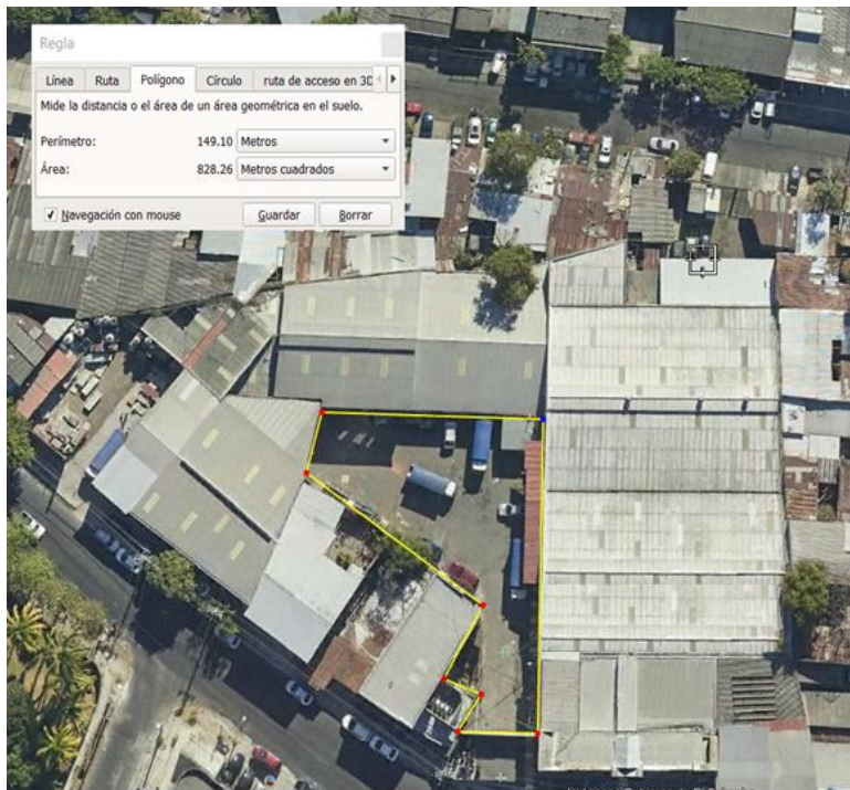
Figura 11. Medición estimada del parqueo interno de la organización mediante Google Earth Pro.
