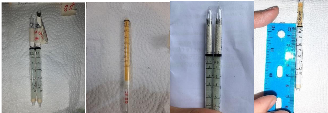
Figura N°37. Lectura de tubos dräger.
