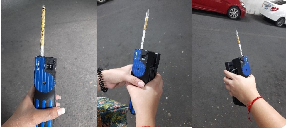
Figura N°36. Toma de muestras con bomba acurro y tubos dräger.
