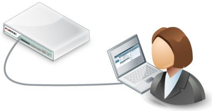
Figura 5.1-2: Conexión por cable consola.
