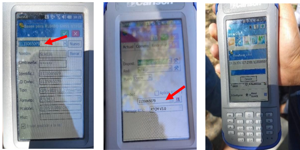
Figura 62. Conexión a la red de la estación de referencia NTRIP
