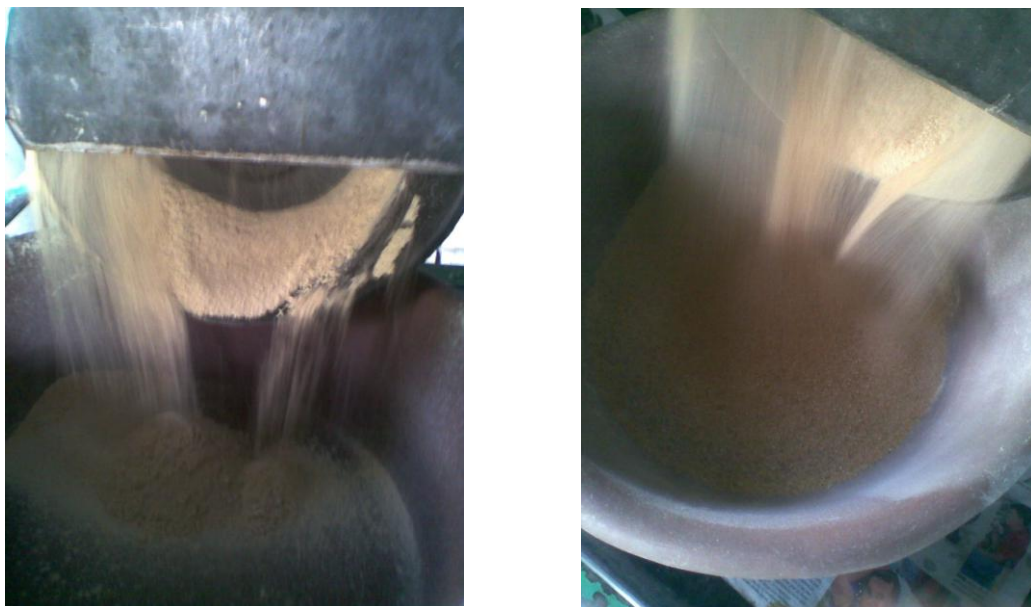
Figura 9. Molido de amaranto tostado y crudo respectivamente, ambos en molino de discos.
