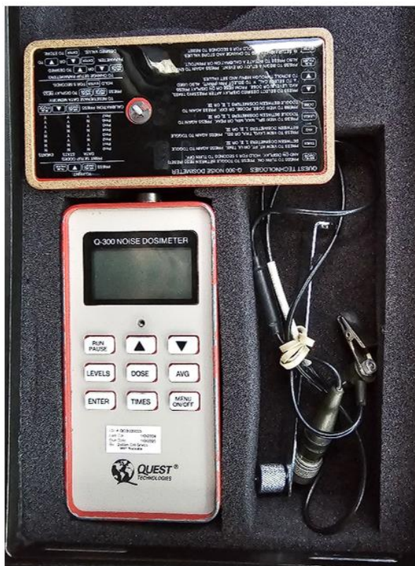
Anexo 5: Audiodosímetro QUEST-Q300 y Tracer ID de calibración técnica
