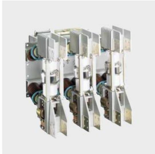
El interruptor de potencia al vacío 3AH3 es libre de mantenimiento a lo largo de toda su vida útil. Es extremadamente potente y domina hasta 10.000 ciclos de maniobra. Este interruptor de potencia se utiliza para altas corrientes de carga de hasta 6300 A y altas corrientes de cortocircuito de hasta 72 kA. Abarca la gama de media tensión común de 7,2 kV a 36 kV.
